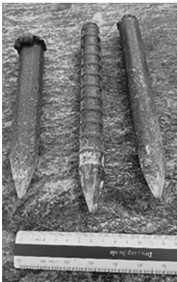
第14図 ノミ 矢を打ち込む穴を作る道具。穴に矢を入れることで、石に亀裂を発生させ、割る。用途に応じて種類がある。発破の火薬を詰める穴をあける時にもノミを使用。
