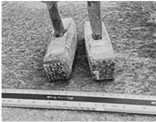
第12図 ビシャン 粗い石の表面をならす道具。石をたたく槌の面に格子状に四角い突起が並んでいる。これでたたくと風合いのある表面仕上げとなる。すべり止めの効果もある。（格子の大きさは大小いくつかある）。
