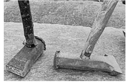
第11図 コヤスケ 一方に刃があり、もう一方を槌でたたいて、石を大きく割りはがす。石を割ったり、石材の角を取って形を整えたりする。
