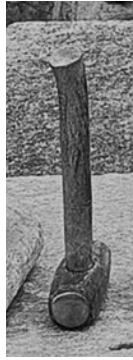
第10図 セツウ（石頭） ノミやコヤスケの頭部をたたく小型のハンマー。 重量は1.2 kg～1.5 kg
