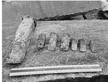
第15図 矢 石を割るための専門道具。ノミで掘った穴に矢を打ち込み、石を割る。この時、経験と勘で「石の目」（割れやすい面）を見定める。日本の伝統的石工技術を支える重要な要素。（スケールは30 cm）
