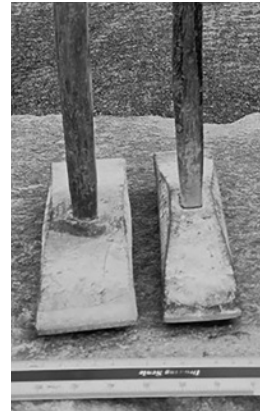
第13図 チョウナ（手斧） 石の表面を削ったりたたいたりして平坦に整えるための伝統的な道具。飛鳥時代（7世紀）頃から使われてきた。刃で細かく平行な線を刻んでいく石材の表面仕上げ方法を小たたきとよぶ。なお、木材用のチョウナとは形や強度が異なる。
